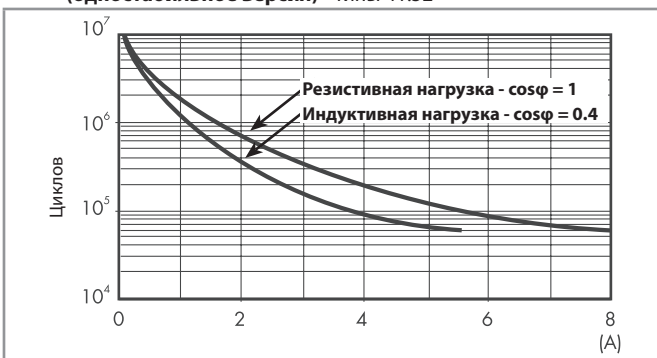
F 41 - Электрическая долговечность (АС) при ном. нагрузке (одностабильная версия) - Типы 41.52
