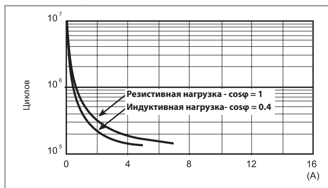
F 55 - Электрическая долговечность (AC) при ном. нагрузке Реле с 4 перекидными контактами
